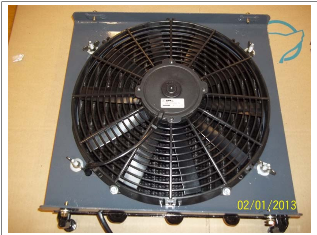
R420 condenser fan
